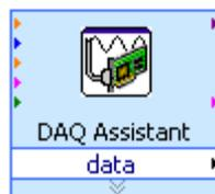
dove è possibile notare la presenza di una variabile *data* che di volta in volta conterrà i/il valori/e acquisiti/o. È comunque possibile modificare le impostazioni dell'acquisizione (per esempio il numero di campioni acquisiti e la frequenza di campionamento) collegando dei controlli agli ingressi presenti a sinistra della funzione.
