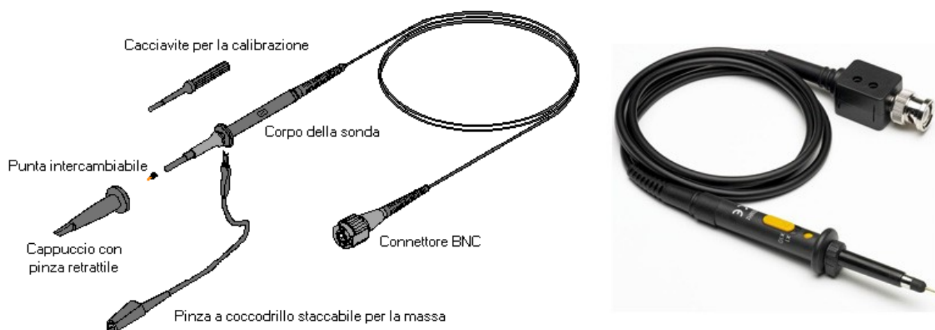
Fig 10 – Schema rappresentativo e foto di una comune sonda per oscilloscopio
