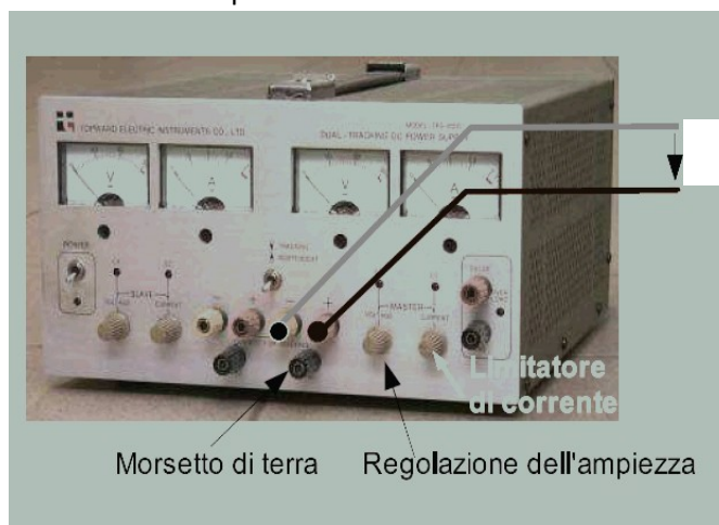
Fig – Alimentatore Topward TPS 4000. Sono indicate le caratteristiche salienti utili all'esecuzione dell'esperienza. Notare la spia, posizionata sopra la manopola per la limitazione della corrente, la cui accensione indica la condizione di cortocircuito tra morsetto positivo e negativo.
