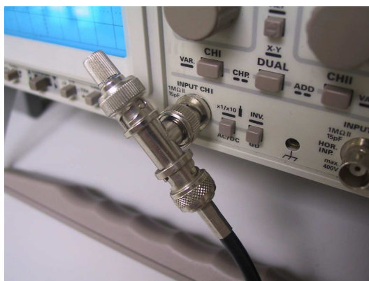
Figura 12: Collegamento del generatore di segnali con l'oscilloscopio in modo da avere il cavo coassiale adattato con un carico di 50\ \Omega .
