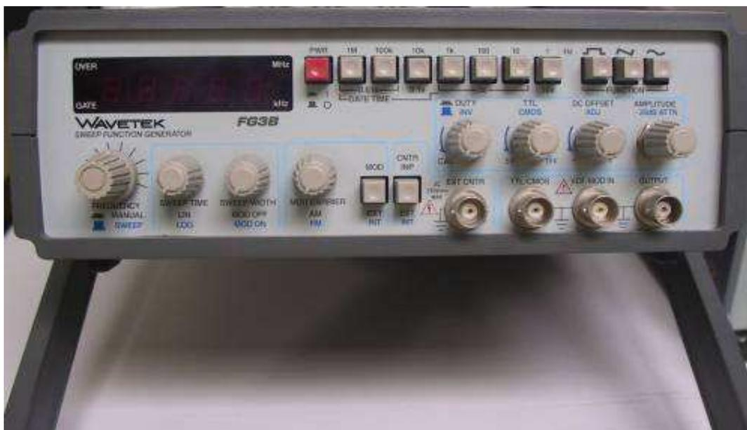
Figura 5: Generatore di funzioni modello Wavetek FG3B.
