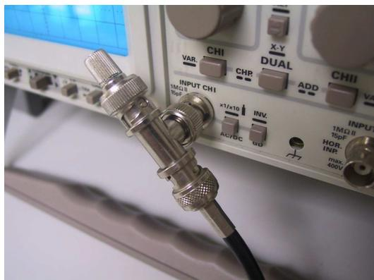
Figura 12: Collegamento del generatore di segnali con l'oscilloscopio in modo da avere il cavo coassiale adattato con un carico di  $50\ \Omega$ .
