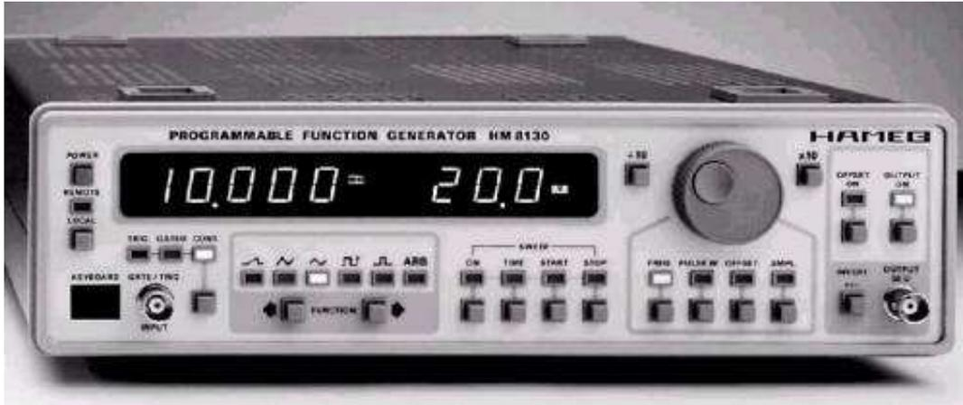
Figura 3: Generatore di funzioni modello Hameg hm8130.
