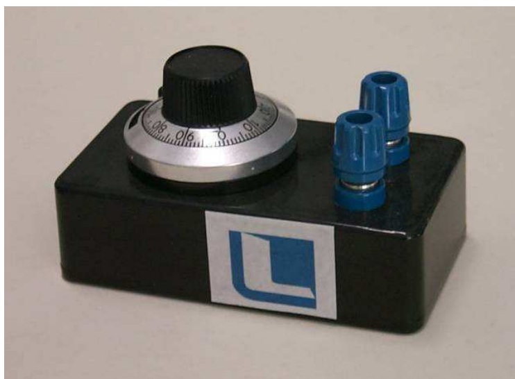
Figura 4: Potenziometro multigiri da 1 k \Omega .
