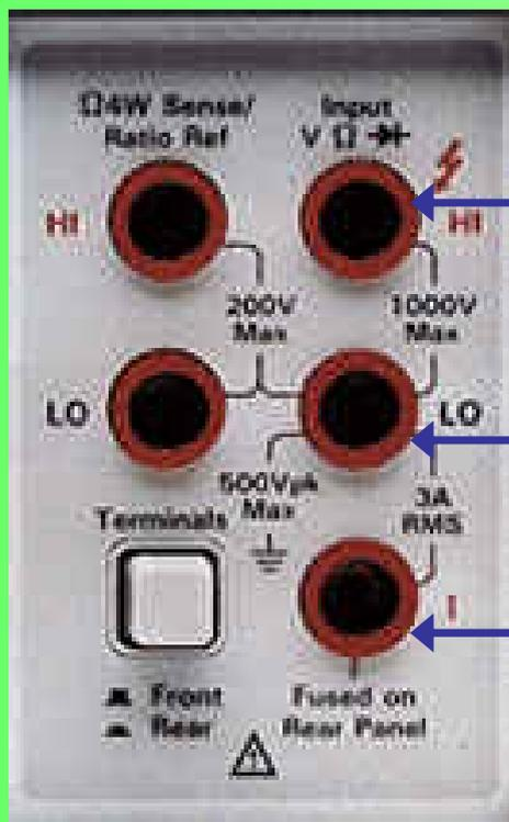
+ Strumento con funzioni voltmetro e ohmetro utilizza i morsetti **HI (High)** e LO (Low)
