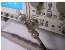
2. Regolate l'oscilloscopio in modo da visualizzare il fronte di salita del segnale (es.  $10 \text{ ns/div}$ ).
